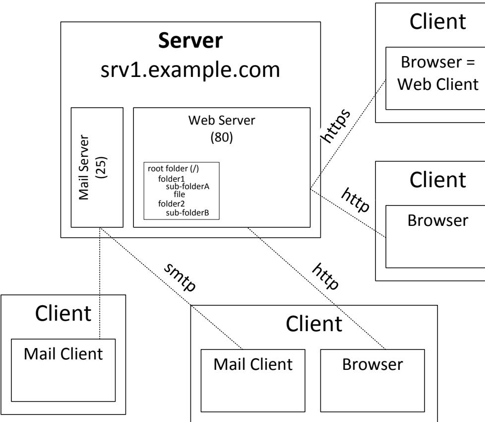
Στο διπλανό σχήμα βλέπουμε έναν **υπολογιστή** που παρέχει **δύο** υπηρεσίες μέσω δύο λογισμικών **Mail Server & Web Server**.
