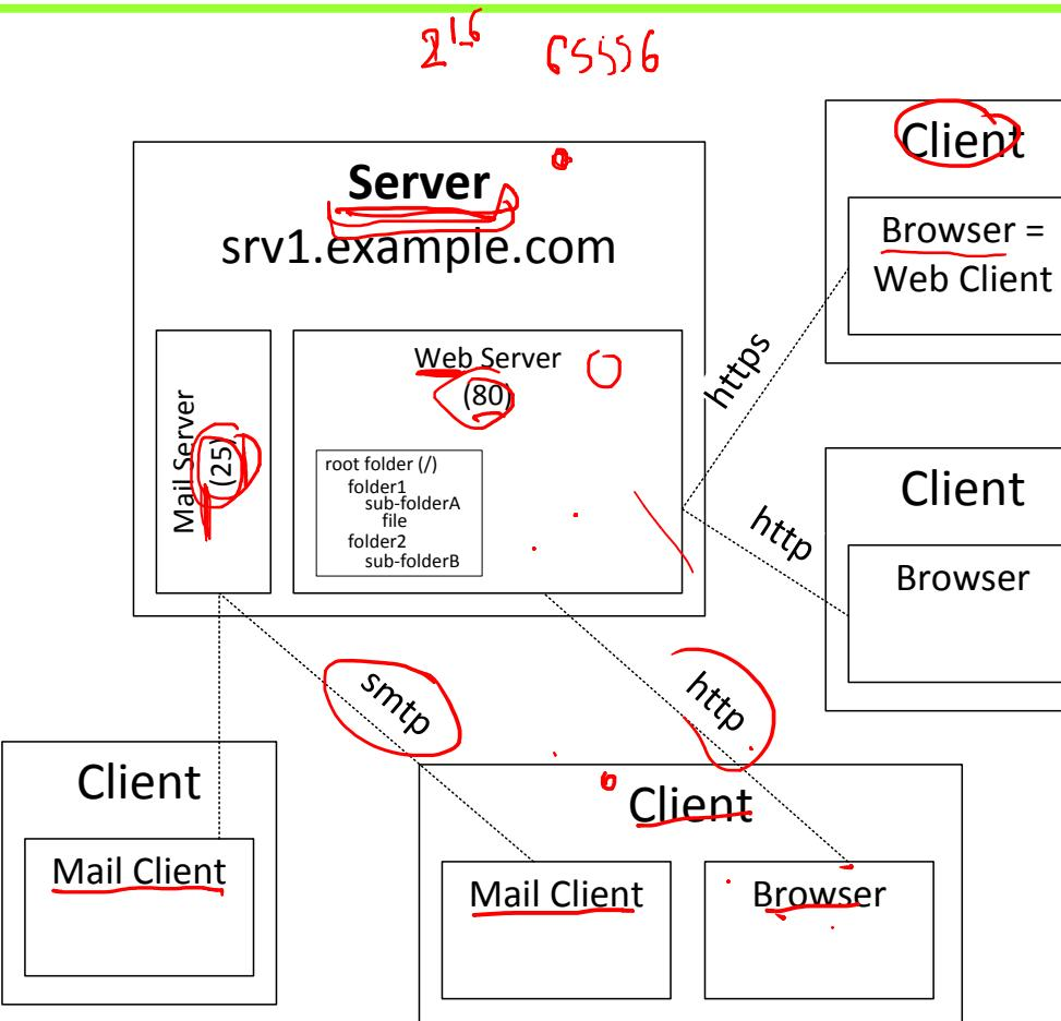
Στο διπλανό σχήμα βλέπουμε έναν **υπολογιστή** που παρέχει **δύο** υπηρεσίες μέσω δύο λογισμικών **Mail Server & Web Server**.
